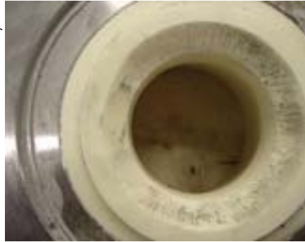
So sieht ein durch Kavitation geschädigtes keramisches Sitzelement eines Kugelventils aus.
