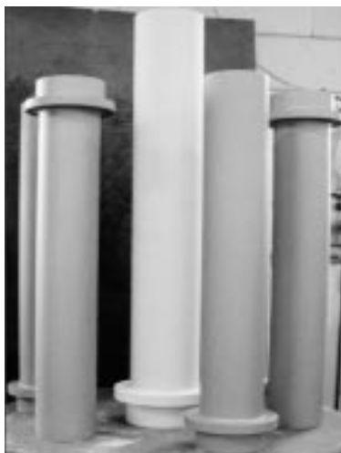
Bild 13 Si 3 N 4 - Steigrohre bis Ø150 mm und 1,25 m Länge (grün und gesintert)
