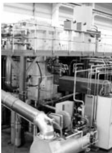
Bild 4 Induktionsbeheizte Inertgas-Sinteröfen mit 700 und 1000 l Nutzraum, thermischer Nachverbrennung und Gasumwälzkühlung
