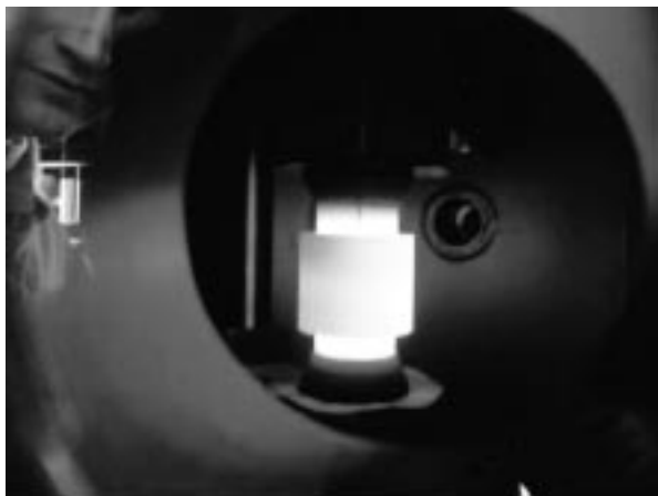
Bild 2 Blick in eine FAST-Anlage bei Betrieb
