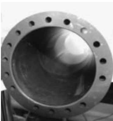
Bild 11 a,b Abrasions- und korrosionsbeanspruchte Komponenten einer Absaugvorrichtung aus SiC; linkes Teil mit durchgehenden Kühlkanälen
