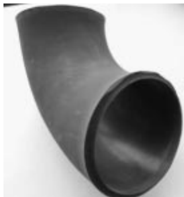
Bild 11 a,b Abrasions- und korrosionsbeanspruchte Komponenten einer Absaugvorrichtung aus SiC; linkes Teil mit durchgehenden Kühlkanälen
